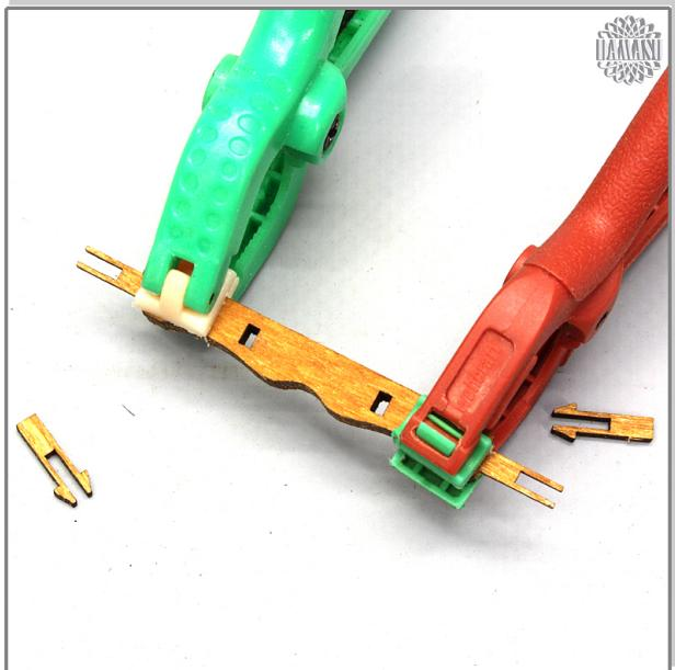
Das Mittelteil der Achse wird an beiden Seiten durch die kleineren Teile verstärkt. Leimen Sie von beiden Seiten je ein Teil an das Mittelteil an. Die Nuten und Durchbrüche der Achse müssen später weitere Teile aufnehmen. Arbeiten Sie auch hier exakt.
