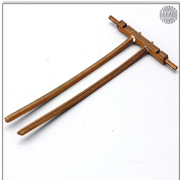
Die fertigen Deichseln werden nun in die Durchbrüche der Achse geleimt. Die Nuten der Achse und die Deichsel spitzen zeigen dabei nach oben.
